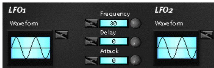
LFO 1 dient der Tonhöhen-Modulation. Mit seiner Hilfe lassen sich typische Vibrato- oder Sirenen-Effekte realisieren. LFO 2 kann sowohl das Filter (Filter-Sweep-Effekte) als auch die Lautstärke (Tremolo-Effekte) modulieren.
