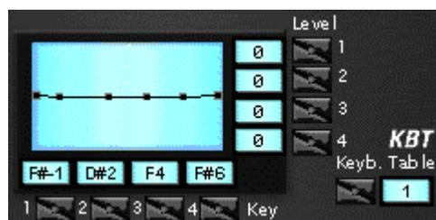
Die EWS64 verfügt über vier unabhängige Keyboard-Tables. Eine Keyboard-Table erzeugt ein Modulationssignal auf Basis einer Kennlinie, die von der Keyboard-Position der gespielten Taste abhängig ist. Eine mögliche Anwendung ist das von anderen Synthesizern bekannte Filter-Tracking, was bedeutet, daß die Cutoff-Frequenz in Abhängigkeit zur gespielten Note verändert wird. Im Klartext: Je höher ein Sample gespielt wird, desto höher ist auch die Cutoff-Frequenz.
