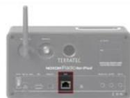
Ici la liaison est établie au moyen d'un câble réseau avec un routeur, un commutateur ou un concentrateur – ou directement avec votre ordinateur au moyen d'un câble crossover (avec câbles de données « croisés »).
